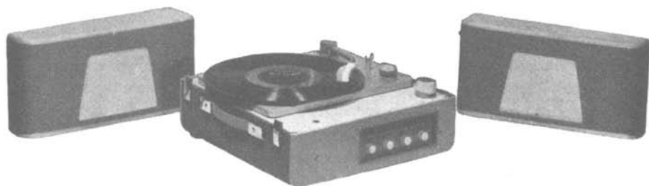
Fig. 2.12. - Esempio di fonovaligia stereofonica. Contiene un amplificatore a due canali, ed è provvista dei controlli di volume e di tonalità. I due altoparlanti formano il coperchio della fonovaligia.
