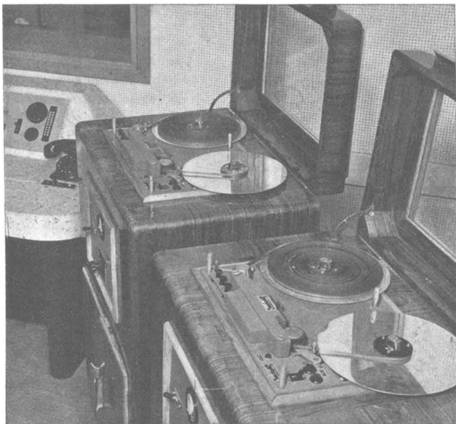
Fig. 13.3. - Registratori magnetici a nastro usati dalla Radio Italiana per le registrazioni da studio. Velocità del nastro: 38,1 cm/sec, oppure 76,2 cm/sec. Gamma acustica da 50 a 10 000 sino a 15 000 c/s, più o meno un decibel. Dinamica di registrazione di 50 dB. Questi apparecchi superano in perfezione qualsiasi altro sistema di registrazione attualmente esistente, compreso il film sonoro. I radioascoltatori non hanno la possibilità di distinguere tra un programma musicale diretto ed uno registrato, al contrario di quanto avviene per i dischi. A seconda delle dimensioni, le bobine consentono registrazioni da 20 a 35 minuti, senza interruzione.
