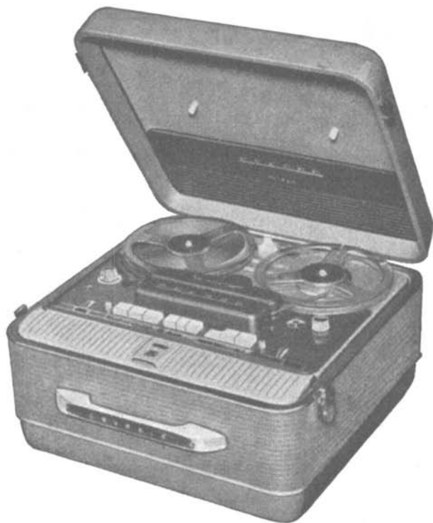
Fig. 14.17. - Esempio di magnetofono con comandi principali e di movimento a tasti, e con inversione automatica della corsa del nastro.
