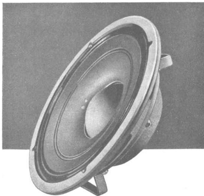
Fig. 3.16. - Altoparlante a cono-membrana, nel quale sono utilizzati i principi dell'altoparlante a cono e dell'altoparlante a tromba, ossia a diffusore diretto ed a compressione. Il cono sostituisce la tromba nella diffusione delle frequenze elevate. Diametro cono 28 centimetri, potenza continua 30 watt (Western Electric).
