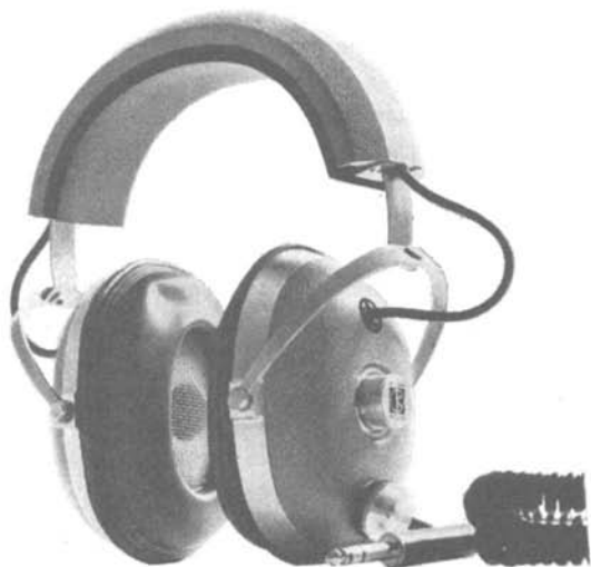
Fig. 3.23. - Cuffia stereofonica con regolatore del volume sonoro.
